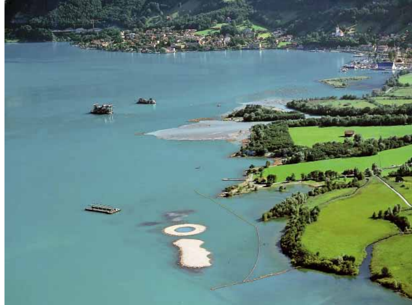
Seeschüttung im Urnersee mit Ausbruchsmaterial aus dem Gotthard-Basistunnel der Neat. – Bild: Niklaus Spoerri
